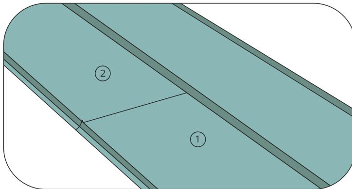
Если длина ската кровли больше длины картин, монтаж производится с нахлестом около 100мм. Картины укладываются в шахматном порядке, минимальное расстояние между стыками – 500 мм.
