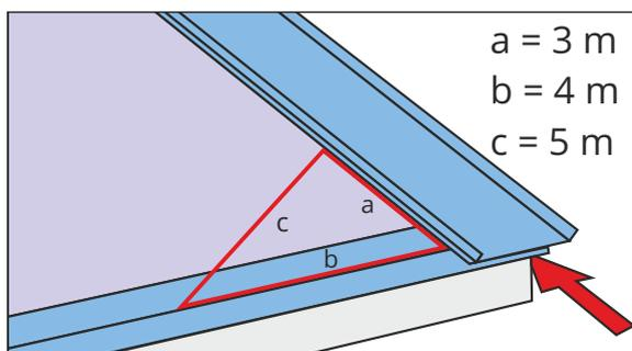
Уложите панель на скат, отступив **50 мм от края торца**. Убедитесь, что **панель** расположена **строго под углом 90°** по отношению к карнизу. Для контроля прямого угла зафиксируйте картину одним саморезом в нижней точке. Отложите вдоль картины 3м, вдоль карниза **4 м**. Если гипотенуза треугольника будет равна 5м, лист можно крепить, так как он находится точно под углом 90грд к карнизной планке.
